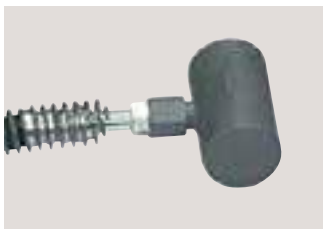
Цилиндрическая замораживающая головка для быстрой смены переходников.
