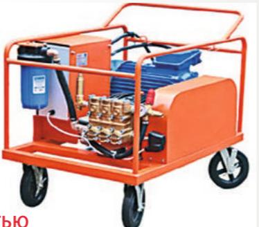
Предназначены для опрессовки (гидростатических испытаний) труб, емкостей, арматуры, реакторов, трубопроводных систем или любых других изделий. Опрессовщики изготовлены на базе современных и надежных итальянских плунжерных насосов.
