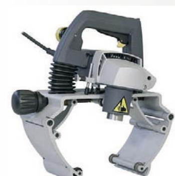
Труборезы Exact Pipe Cutting и фаскосниматели PipeBevel разработаны для профессионального использования. Они легки при переноске и просты в работе. Также могут быть использованы для резки стальных, пластиковых, медных, чугунных, нержавеющих и многослойных труб. Продукция Exact используется по всему миру и зарекомендовала себя с наилучшей стороны.
