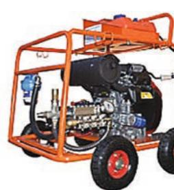
Применяются для очистки в различных отраслях: строительства, реконструкция мостов, очистка котлов и теплообменников, очистка корпусов судов и причалов от наростов и водорослей, водопескоструйной очистки металлоконструкций, очистка от нагара, прочистка труб заводов и ЖКХ.
