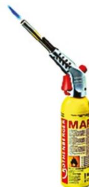
Профессиональная горелка с пьезоподжигом для пайки твердым припоем труб, диаметром до 28 мм, и пайки мягким припоем труб, диаметром до 35 мм. Подходит для огневой зачистки. Максимальная температура горения - 2700 °С. Благодаря встроенному вентилю производится точная регулировка силы пламени. Подходит для использования в любом положении (360 °С). Уникальная система «Twist 'N' Load» (5 разных наконечников) входит в комплект.
