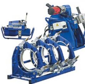
Аппараты с гидравлическим приводом для стыковой сварки труб из полимерных материалов (ПЭ, ПП и ПВХ и других термопластичных труб и фасонных частей) диаметром от 40 мм до 1600 мм. Благодаря самоцентрирующемуся каркасу и компактной конструкции машины успешно применяются при строительстве водопроводов, газопроводов, дорог, кюветов, канализационных и оросительных систем.
