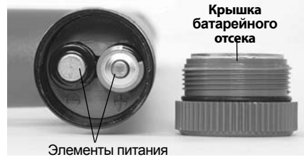
Рис. 7 – Замена элементов питания (приемник)
