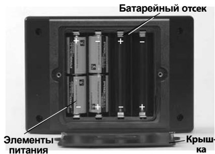
Рис. 6 – Замена элементов питания (передатчик)
