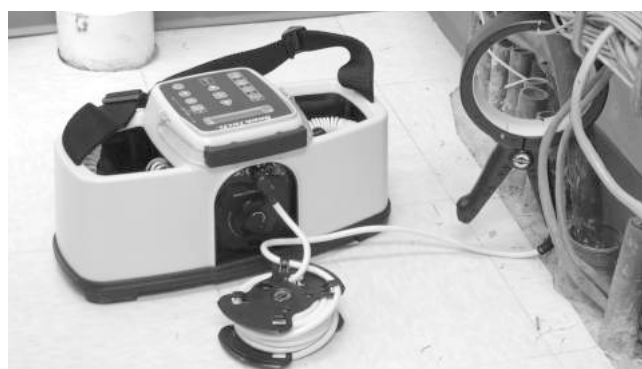
Рис. 12 – индукционный зажим подключен к проводнику
