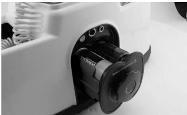
Рис. 6 – извлечение аккумуляторного отсека
