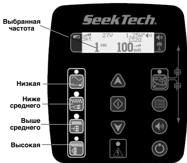
Рис. 19 – кнопки выбора частоты – приемник/локатор сторонних производителей
